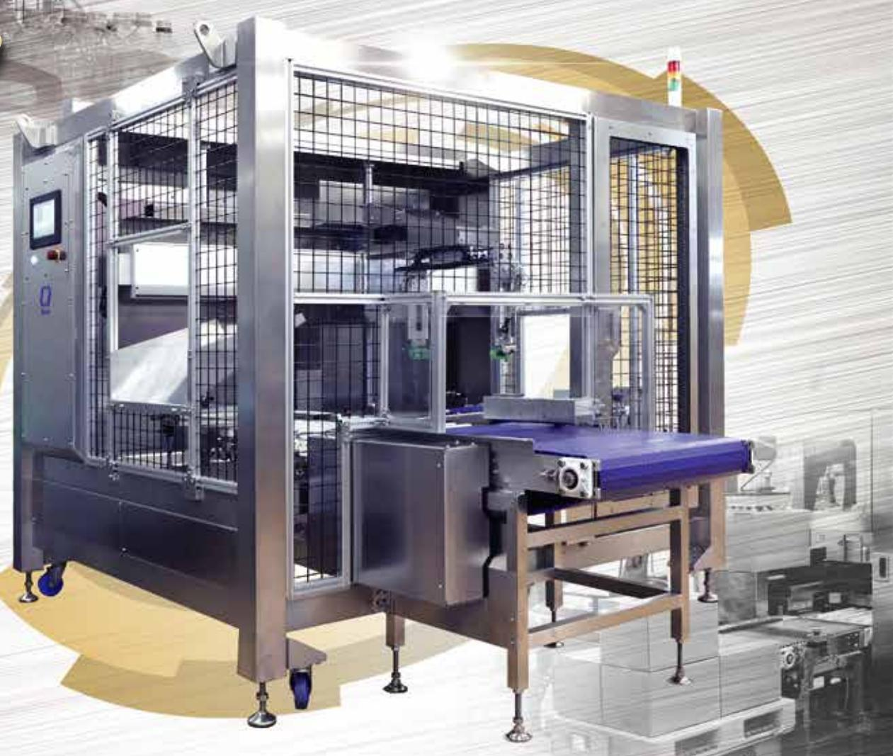
原料段ボールケースの開梱と原料の取り出しを自動化
