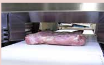
4セットのカメラで搬送中に正確なスキャンを行ないます。
