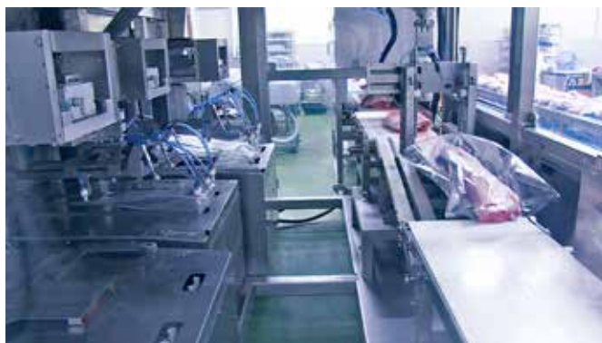
■ロボットによる部分肉の袋詰めと袋供給装置(左)
