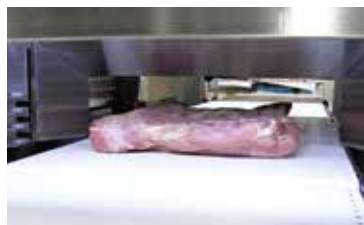
4セットのカメラで搬送中に正確なスキャンを行ないます。
