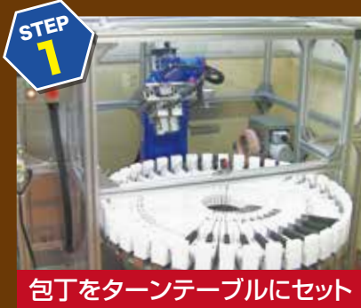
ロボットが自動的に研磨作業開始
