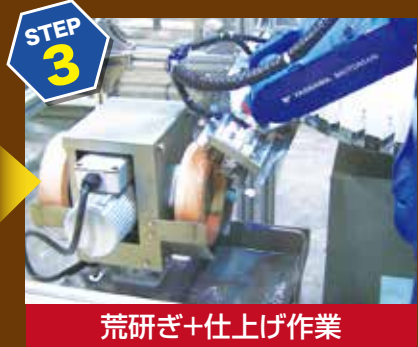
ロボットが自動的に研磨作業開始
