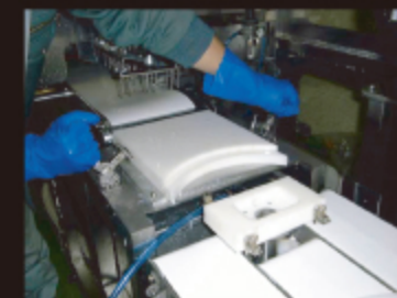
まな板はクランプを外せば、簡単に取り外しができ、漬け置き洗いが可能です。
