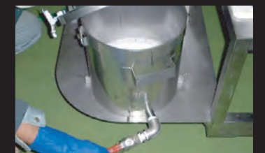
真空缸 为固定切断物体，真空吸引，会有积水。 真空缸排水也可一次性简单操作。
